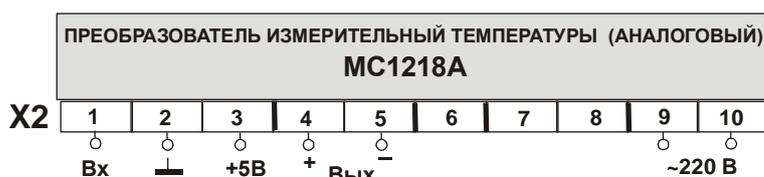
Рисунок 2.2. Схема подключения ПИ
