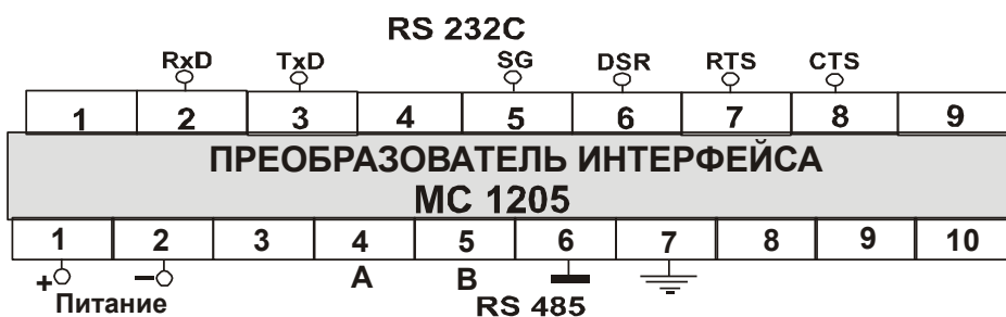
Рисунок 2.2 – Схема подключения МС1205
