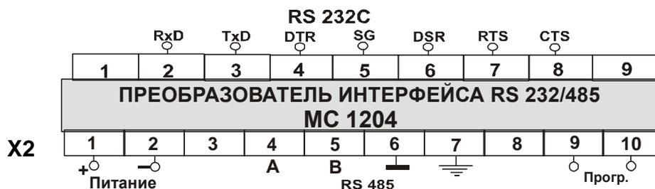
Рисунок 2.2 – Схема подключения МС1204
