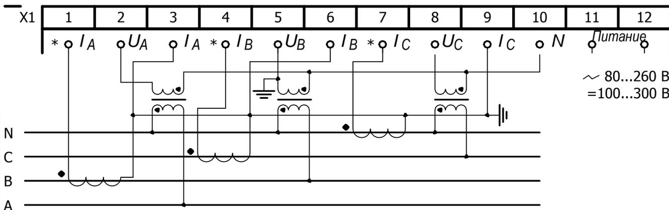
Рисунок Б.8 – Схема подключения ПЦ к четырехпроводной сети с заземленной фазой В
