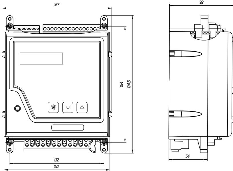
Рисунок А.2 – Габаритные и присоединительные размеры ПЦ6806-03(М) со снятыми крышками зажимов
