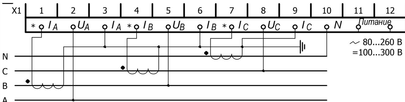
Рисунок Б.9 – Схема подключения ПЦ к четырехпроводной сети 220 В без трансформаторов напряжения
