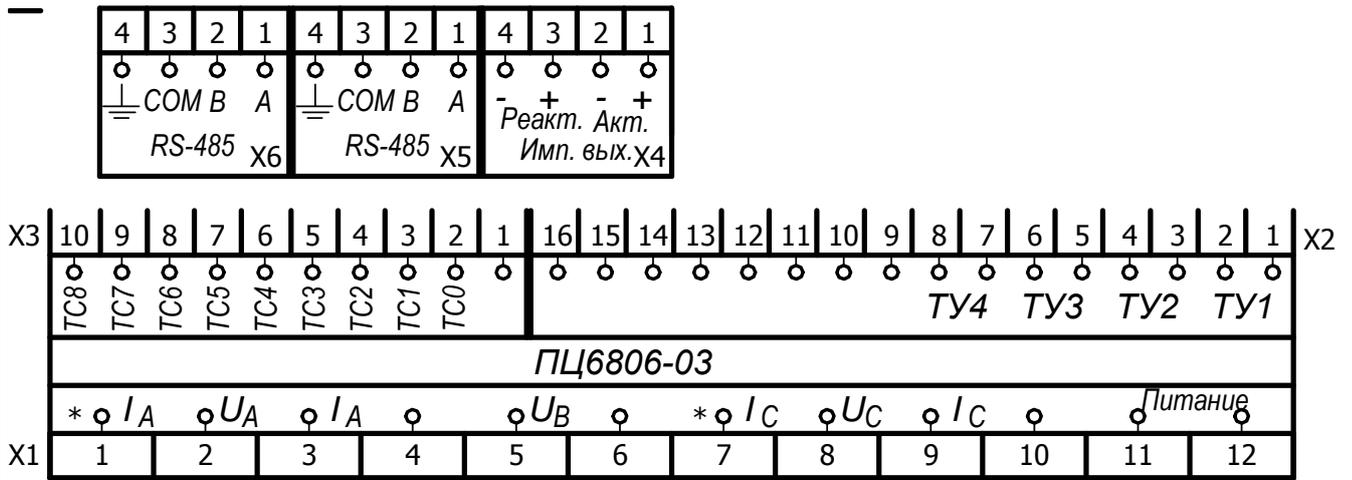
Рисунок Б.1 – Расположение выводов ПЦ6806-03(М)/2Х-ХХ-А2, ПЦ6806-03(М)/4Х-ХХ-А2
