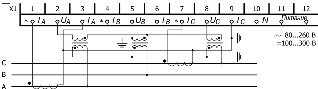
Рисунок Б.5 – Схема подключения ПЦ к трехпроводной сети с тремя трансформаторами напряжения и заземленной фазой В
