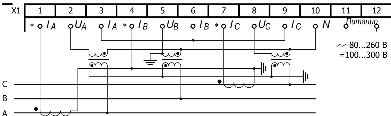
Рисунок Б.6 – Схема подключения ПЦ к трехпроводной сети с двумя трансформаторами тока и тремя трансформаторами напряжения и заземленной фазой В
