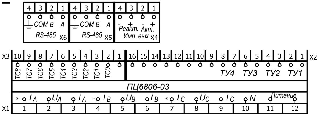
Рисунок Б.2 – Расположение выводов ПЦ6806-03(М)/1Х-ХХ-А2, ПЦ6806-03(М)/3Х-ХХ-А2, ПЦ6806-03(М)/5Х-ХХ-А2
