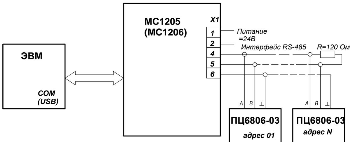
Рисунок Б.3 – Схема подключения ПЦ6806-03 к ЭВМ
