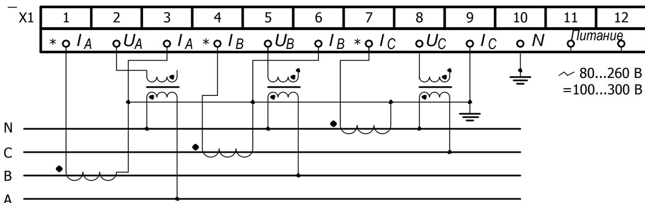
Рисунок Б.7 – Схема подключения ПЦ к четырехпроводной сети
