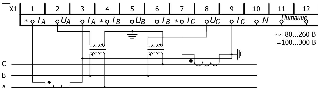
Рисунок Б.4 – Схема подключения ПЦ к трехпроводной сети с двумя трансформаторами напряжения
